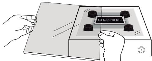
Coloque um pedaço de guarnição em cada canto do vidro para que haja equilíbrio. Após, coloque o segundo vidro em cima da folha base.
