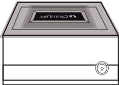
Coloque os vidros com o lado da **folha base para baixo e do negativo para cima** e feche a lona protetora.
