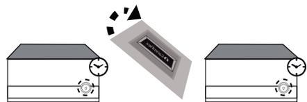
Ligue a lâmpada e deixe ligada de **15 à 25 segundos**. Após, vire o lado do vidro, feche a lona e deixe ligada de **90 à 120 segundos**.
