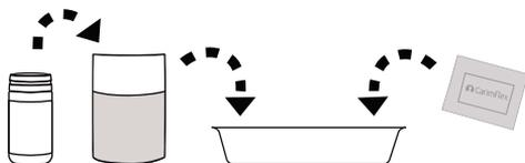
O carimbo ficará pegajoso, para reduzir essa viscosidade será realizado o banho final. Dissolva **100gr de Xelfmirac em 500ml de água**, posteriormente despeje na banheira e coloque o carimbo dentro.
