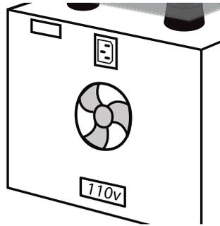
Verifique a voltagem na parte traseira da máquina e conecte à uma tomada compatível. **Não ligue se a voltagem for diferente (110v ≠ 220v).**
