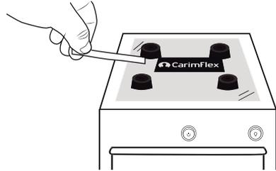
Coloque a folha pet sobre o negativo. Em seguida, coloque as guarnições rentes ao mesmo.
